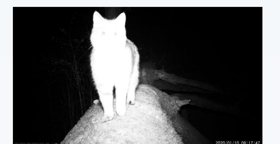
Vadmacska figyel egy hagyományos vadkamerát. A közeli felvételek túlexponáltak a NIR LED-ek és a dinamikus fénymérés hiánya miatt.
